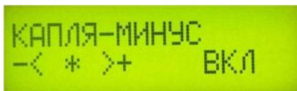
Рисунок 6. Экран функции отсечки последней капли.
